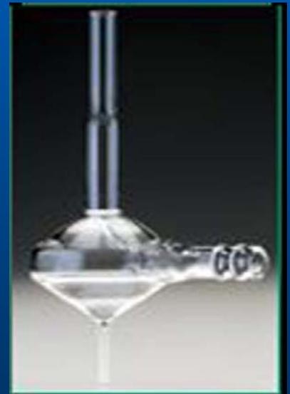
**筒型雾化室**是利用雾化室内壁上的湍流沉降作用，或利用重力作用除去较大的雾滴。在早期的ICP中，筒型雾化室用得较为普遍。
